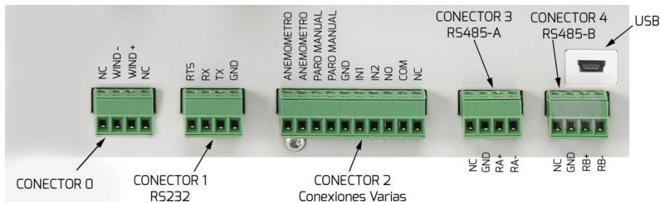
Existen 5 conectores. Cada conector tiene una utilidad específica:
